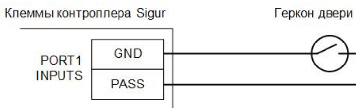
Подключение датчика открытия дверей.
