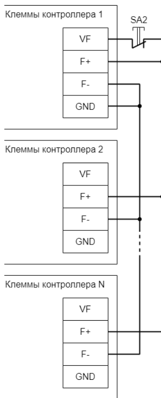
Подключение кнопки разблокирования к нескольким контроллерам.
